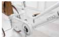
低床フレーム お子様がまたぎやすい設計のフレーム
